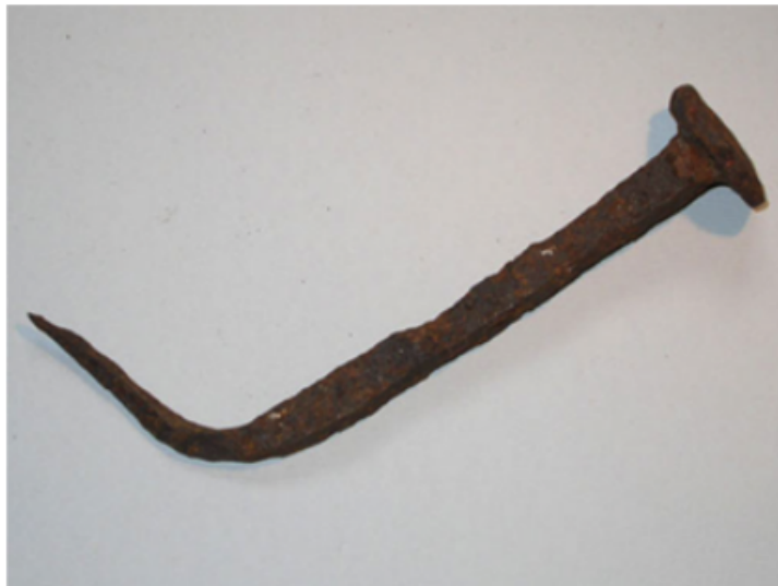
Gambar 3.1: Korosi seragam pada paku (Pedferri and Lazzari, 2018)
