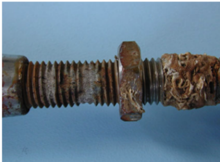
Gambar 3.9: Korosi celah pada stainless steel dalam air laut (Pedferri and Lazzari, 2018)
